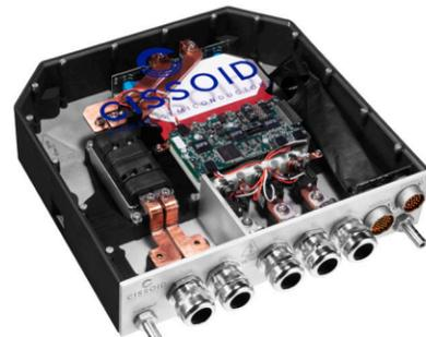
图 1. CISSOID 的高压 SiC 逆变器参考设计。
