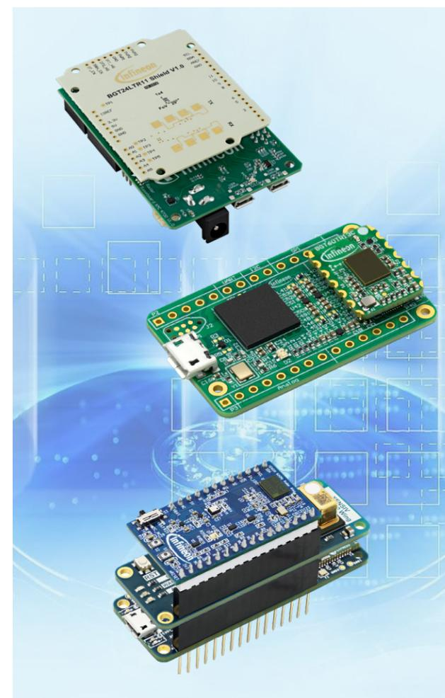
图 3: 雷达配套开发套件: 24 GHz 演示板 Distance2goL (左)、演示板 BGT60TR13C MMIC (中) 和 60 GHz 连接传感器套件 (右)
